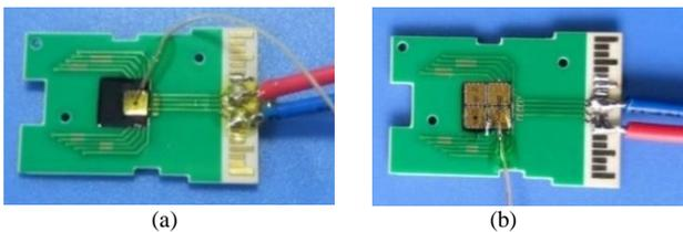
Fig. 4. TTV samples: (a) TTV1; (b) TTV2
