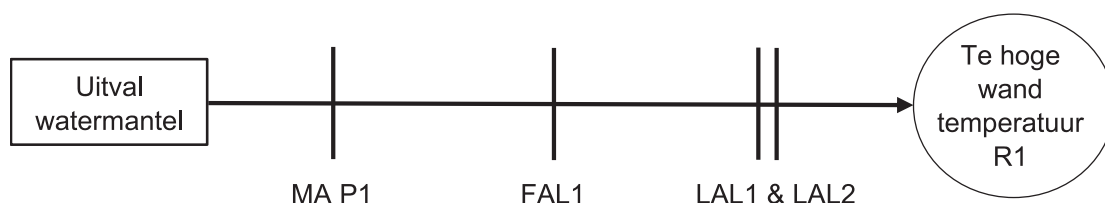
Figuur 8 Scenario 'te hoge wandtemperatuur R1' door uitval watermantel
