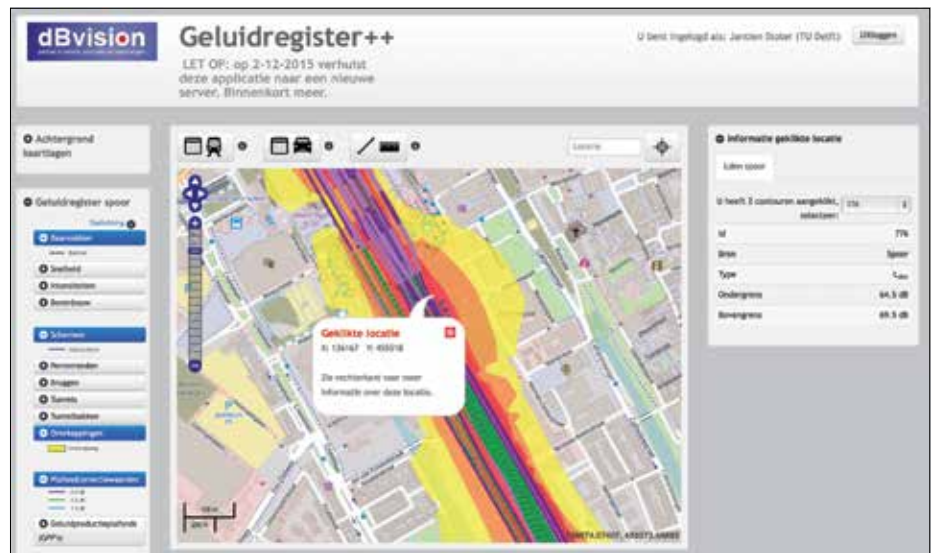
Figuur 5 - Geluidregister++ van dBvision: een webapplicatie waarbij de gebruiker het effect van een (hoger) geluidscherm eenvoudig kan laten berekenen in 3D.
