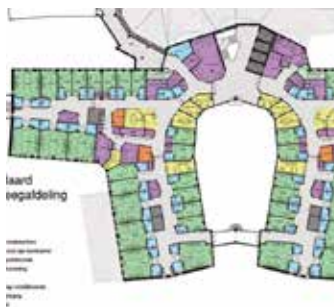
FIGUUR 7.50 plattegrond standaard verpleegafdeling paars = facilitaire ruimten, geel = werkgebied personeel oranje = behandeling onderzoek
