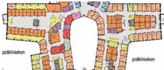
FIGUUR 7.40 plattegrond vlinder polikliniek met links poli snijdende specialisten en rechts poli beschouwende specialisten
