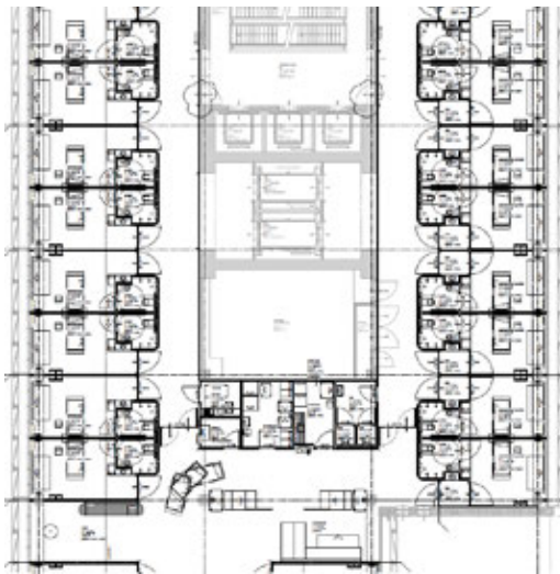
FIGUUR 11.23 fragment plattegrond 11 e verdieping
