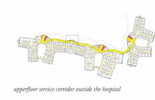
FIGUUR 7.31 overzichtsplattegrond eerste verdieping met ontsluitingsprincipe (legenda: geel gang staf met rood de liftkernen)
