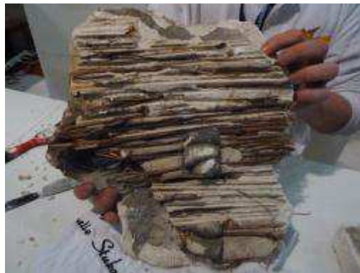
Fig. 30. Riet gebruikt als stucdrager driedimensionaal element, Neerlandsch Stucgilde.
