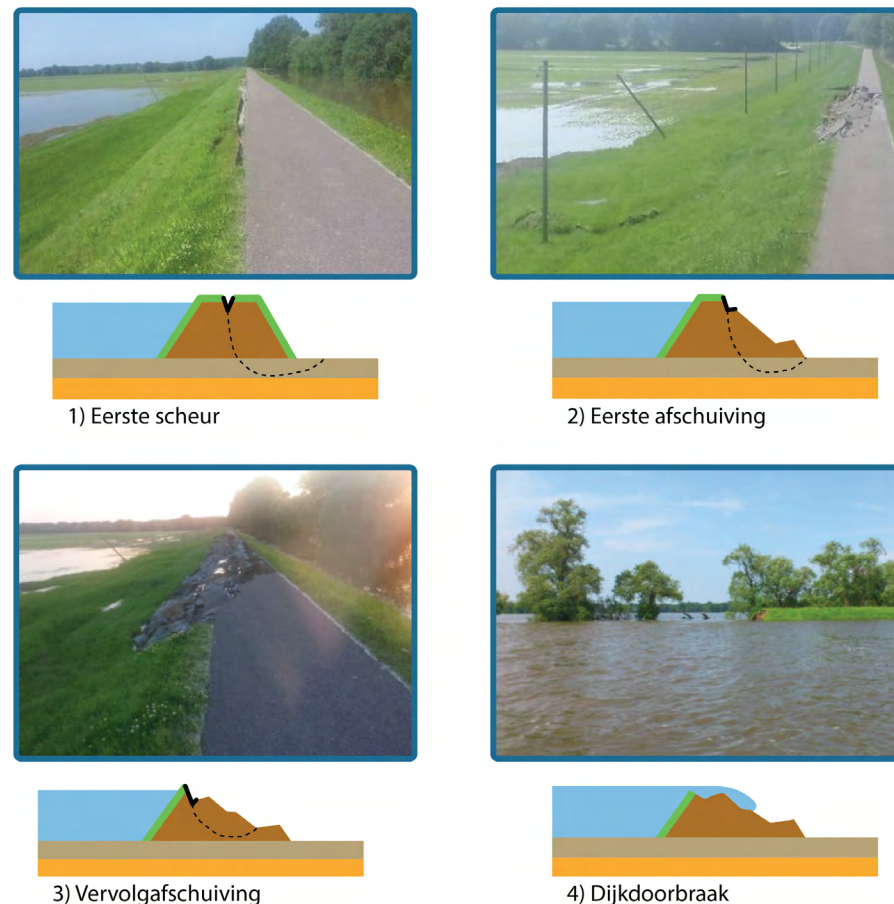
Figuur 2: Opeenvolging van hellingsinstabiliteiten die tot overstromingen leiden. Foto's van Grubert (2013) en schema's aangepast van Calle & Knoeff (2002).
