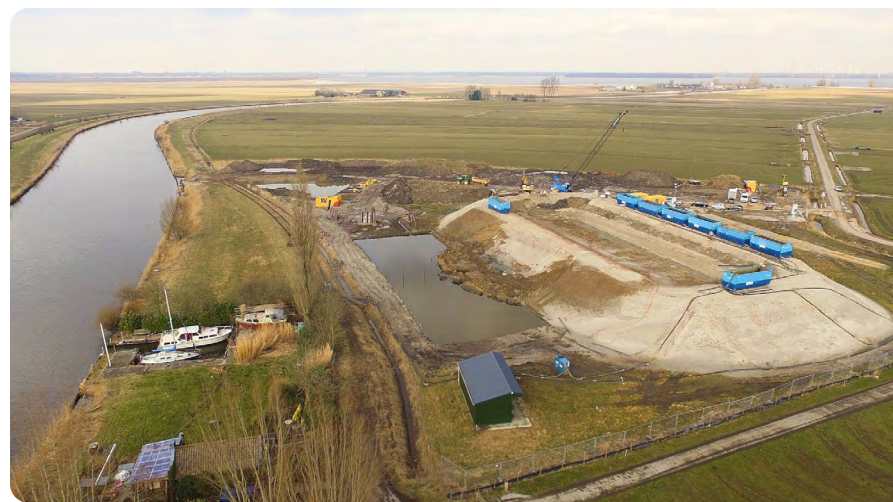
Figuur 1: De testopstelling van de Eemdijkproef gezien vanuit de lucht. Photo © NOS / Eric Feijten.
