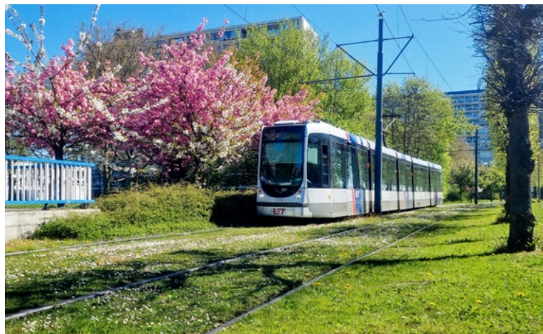
Een groene trambaan in het Mekelpark zorgt voor inpassing in het landschap en regenwateropname, Rotterdam.
