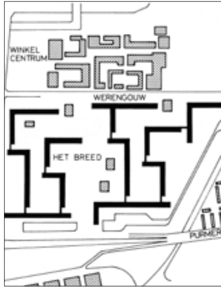
HET BREED, AMSTERDAM-BUIKSLOTERHAM, 1962-1968 Architect F.J. van Gool | 1161 dwellings | courtyards 38 × 52, 68 × 88, 86 × 122 m
