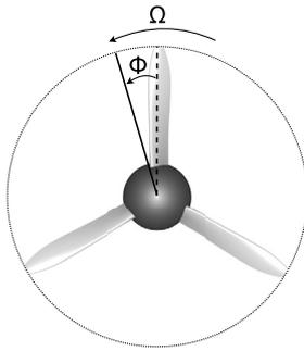
Fig. 7. Definition of phase angle ( $\phi$ ).
