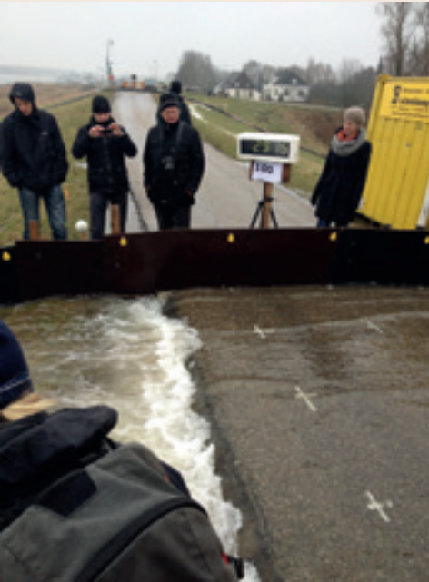
Figure 4. Wave overtopping experiment at Millingen aan de Rijn (Photo courtesy Juan Pablo Aguilar-López).
