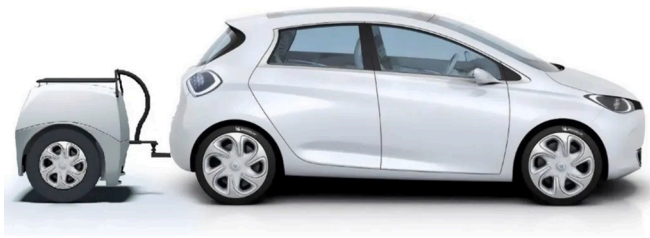
Fig. 9. Battery trailer for range extension (Berman, 2020).
