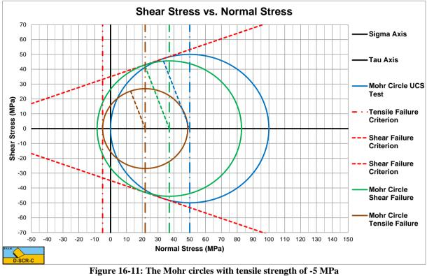
(UCS=100 MPa, φ=20°). Tensile Failure.
