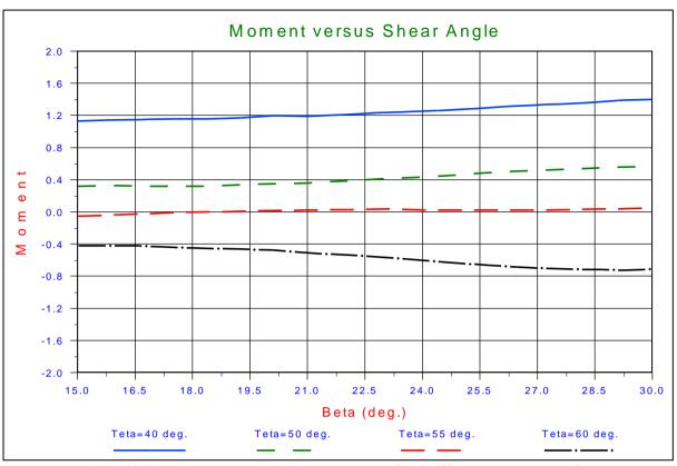
Figure 12-20: The moment versus the shear angle for 4 different wedge angles for:  $\alpha=90^{0}$ ;  $\delta=28^{0}$ ;  $\phi=42^{0}$ ;  $h_{i}=1$ ;  $h_{b}=3$ ;  $k_{i}/k_{max}=0.25$
