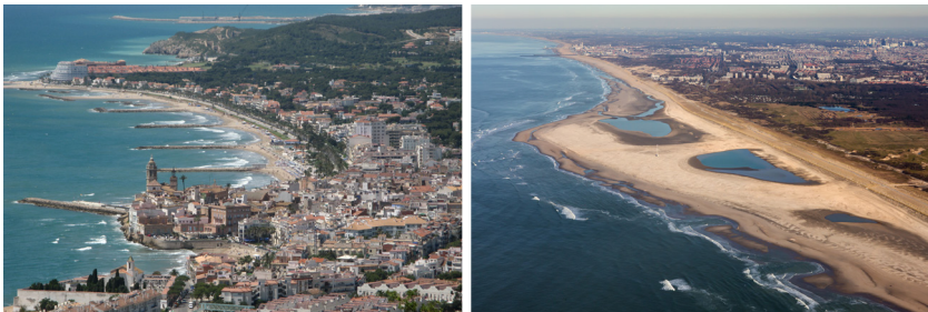
Fig. 6: Kustlijn met golfbrekers en strekdammen (Sitges, Spanje, links) en Pilot Zandmotor Delfland dd. 16 februari 2016 (rechts)
