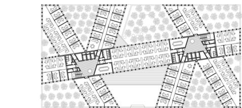
A primera vista, el edificio se muestra como una serie de barras que se intersecan con cierta libertad geométrica hasta alcanzar el perímetro rectangular de la manzana. La estructura del edificio sobre rasante se concentra en las fachadas, lo que dota a los espacios para oficinas de una gran flexibilidad.
