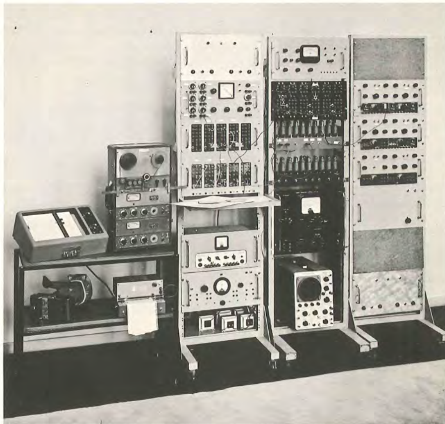
Foto 8 Analoge rekenmachine met 20 versterkers, 4 vermenigvuldigers, magneetband voor simulering van voortplantingstijden, laagfrequent ruisgenerator, functiegenerator, niet-lineaire elementen en registreertoestellen
