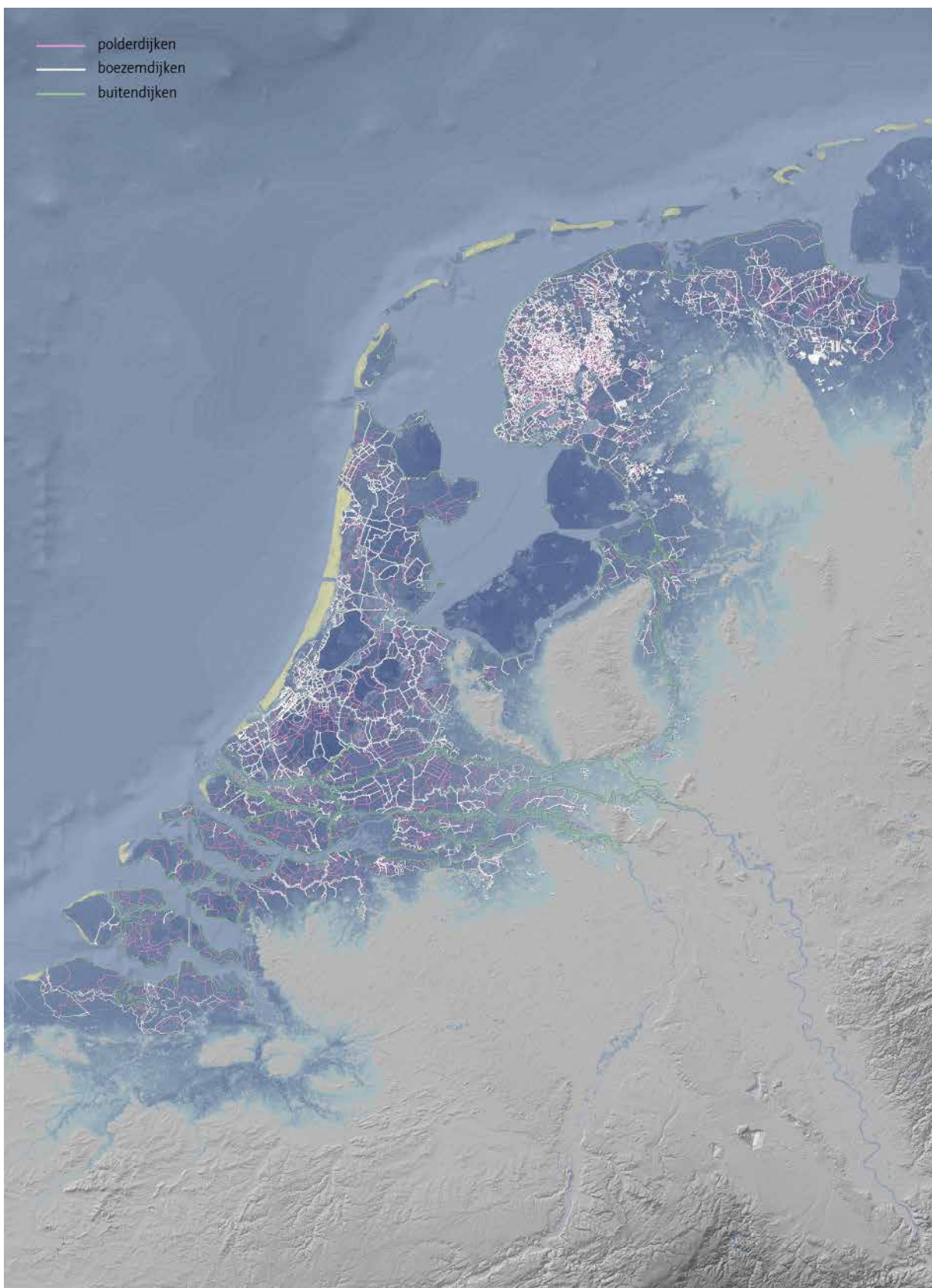
ILLUSTRATIE 3.5 Dijkenkaart waarin polderdijken, boezemdijken en buitendijken zijn onderscheiden in combinatie met de hoogtekaart.
