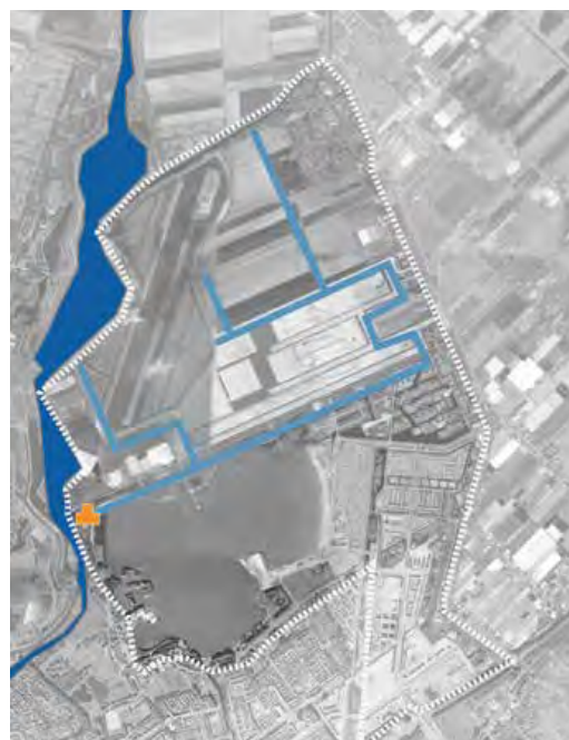
ILLUSTRATIE 6.35 Huidig werking watersysteem Eendragtspolder.
