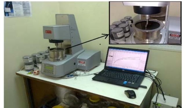
Şekil 1. Karışımların reometre kullanılarak test edilmesi (Testing of the mixtures by using reometer)
