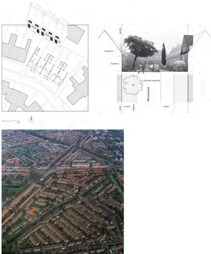
Afbeelding 10.1.4 Stedenbouwkundige plananalyse van het ontwerp van Hein Berlage, Marinus Granpré Molière en Piet Verhagen voor een deel van de wijk Vreewijk in Rotterdam uit 1913-1920 (luchtfoto onder). De analyse (boven) richt zich op de functionele en ruimtelijke aspecten van de overgang tussen de woningen en de straat. Er is gebruik gemaakt van combinaties van verschillende typen tekeningen, zoals een fragment van het stedenbouwkundig plan, woningplattegronden en daarboven een axonometrische tekening van de bouwmassa (linksboven), en een foto van de straat gemonteerd in een sterk geschematiseerde doorsnede met daaronder een plattegrondfragment (rechtsboven).
