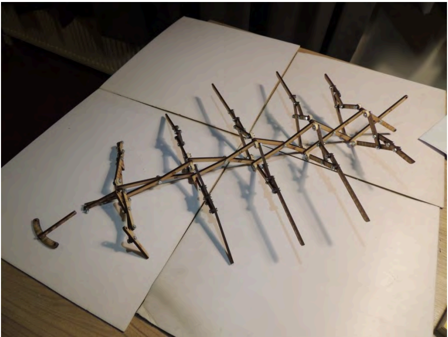
Fig.15.1.4 functiemodel van een zonluifel 1:5 (door: Krittika Agarwal, Priyadarshini Nanda, Shweta Kamble, Pierre Kauter en Okan Türkan, gebruik met toestemming).
