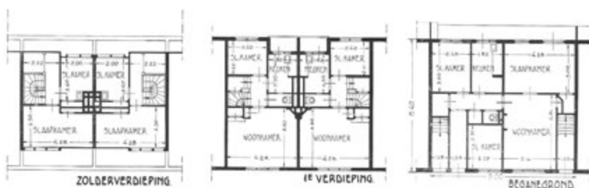
FIG. 7 Plattegrond type beneden- en bovenwoning Spoorwijk [uit: Bakker Schut, De volkshuisvesting te 's-Gravenhage , 64]
