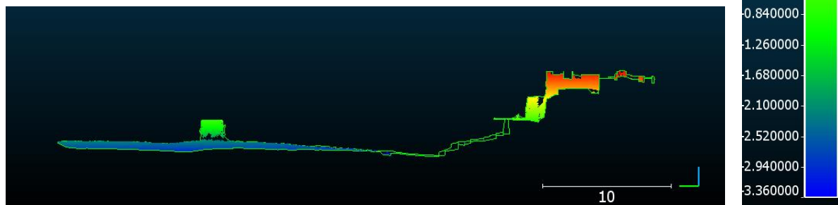
Figuur 4.21 Doorsnede meest diep 2020 (rechts in figuur hierboven), max diepte 3,36m
